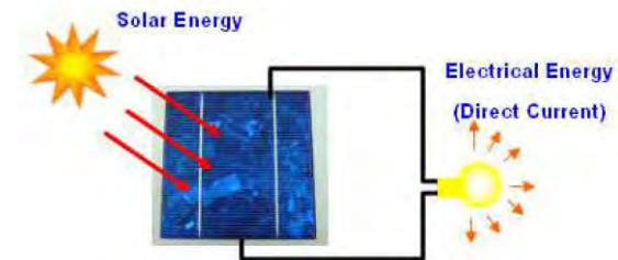
รูปที่ 1 เซลล์แสงอาทิตย์ทำงานเมื่อมีแสงตกกระทบ
