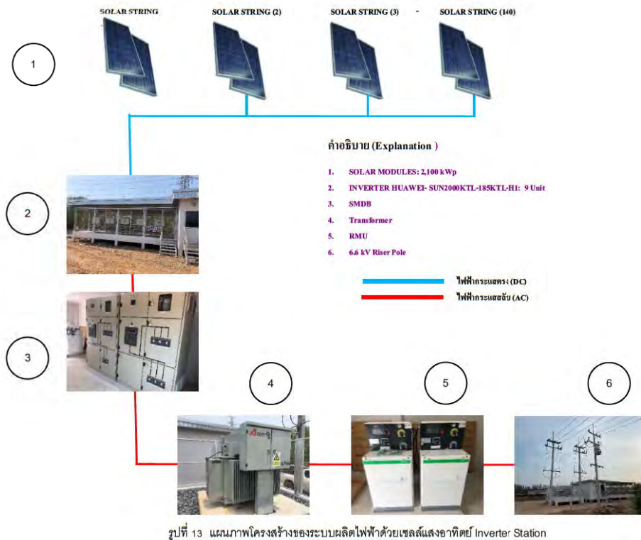
รูปที่ 13 แผนภาพโครงสร้างของระบบผลิตไฟฟ้าด้วยเซลล์แสงอาทิตย์ Inverter Station
